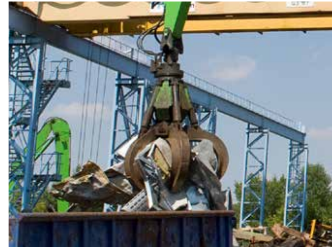
Portakal kabuğu kavrayıcı (SGM), yarı açık kabuk şekli, örneğin karışık hurda için
