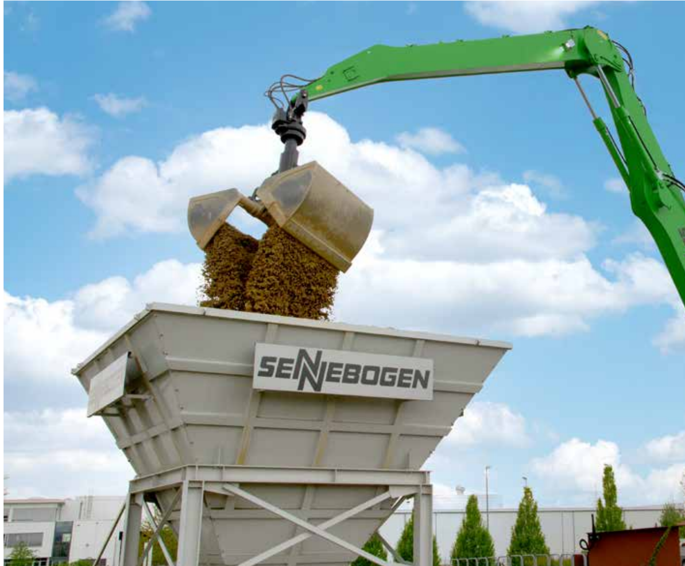
İki kapaklı kavrayıcı ile (SGZ) dökme malzeme (yem, kömür, vs.)
