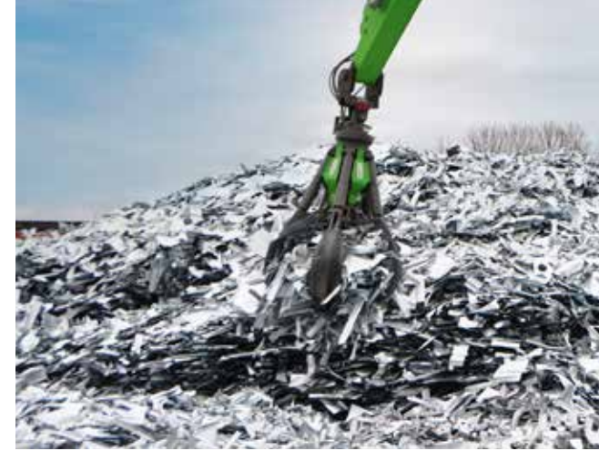
Portakal kabuğu kavrayıcı (SGM), yarı açık kabuk şekli, örneğin sac hurdası için
