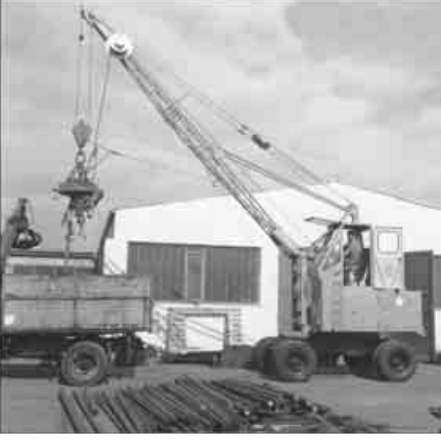
1962: Halatlarla çalıştırılan yükseltölmüş operatör kabinli S833
