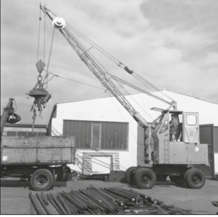
1962: Halatlarla çalıştırılan yükseltilmiş operatör kabinli S833
