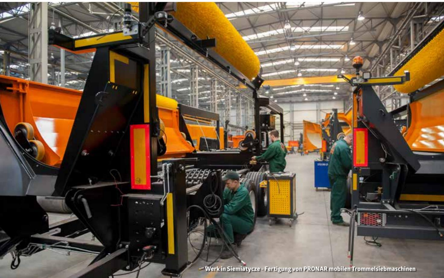
Werk in Siemiatycze - Fertigung von PRONAR mobilen Trommelsiebmaschinen
