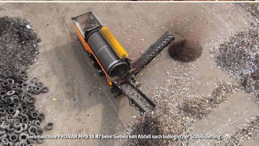
Siebmaschine PRONAR MPB 18.47 beim Sieben von Abfall nach biologischer Stabilisierung.
