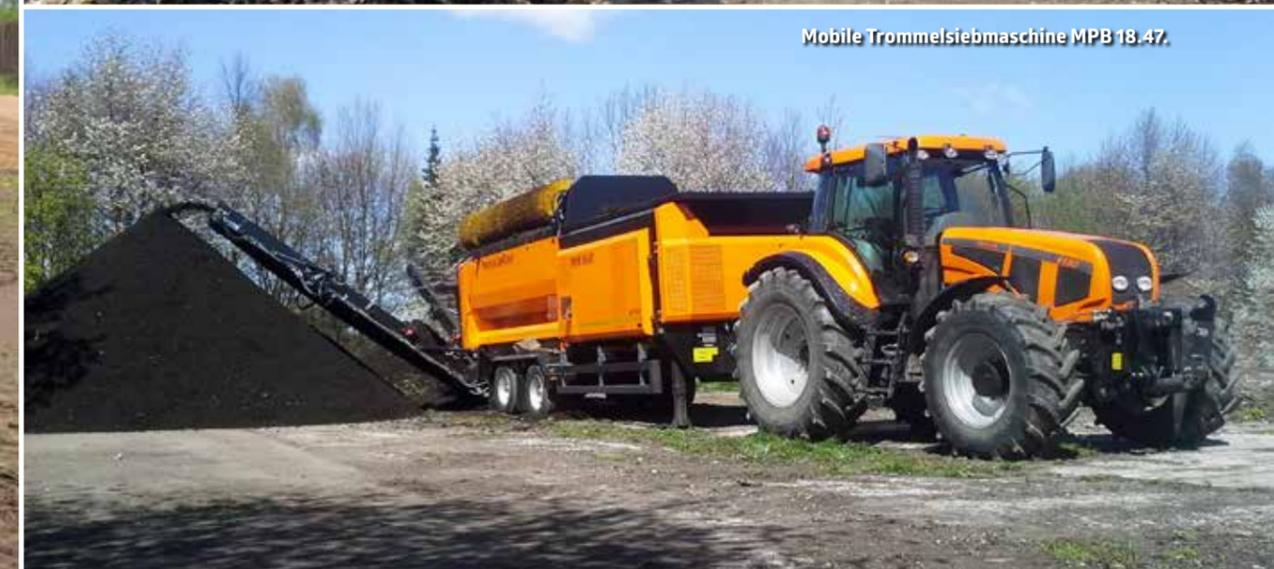
Mobile Trommelsiebmaschine MPB 18.47.
