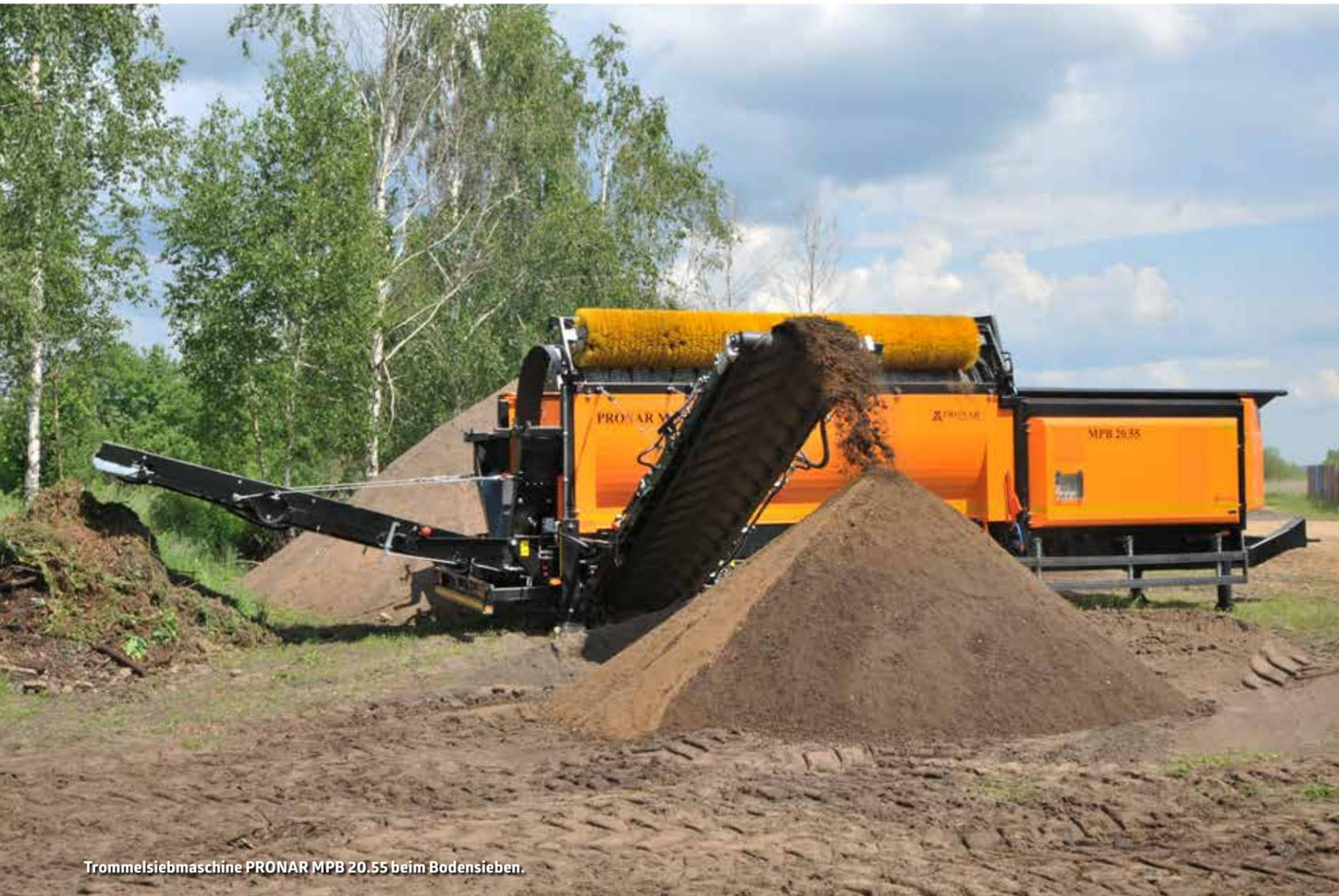
Trommelsiebmaschine PRONAR MPB 20.55 beim Bodensieben.
