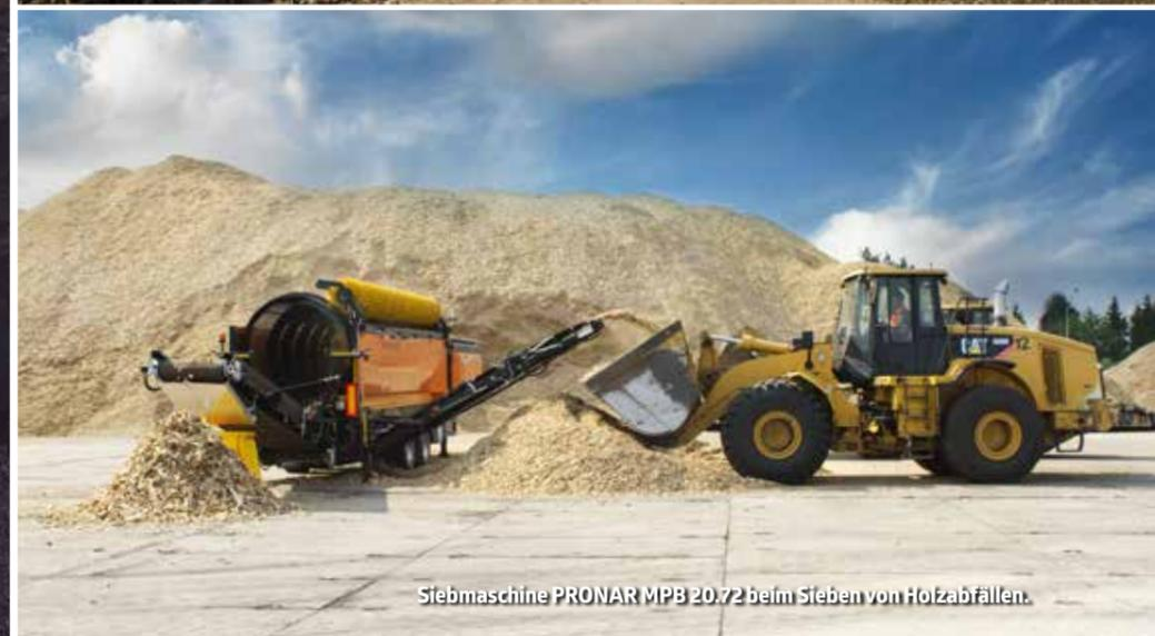
Siebmaschine PRONAR MPB 20.72 beim Sieben von Holzabfällen.
