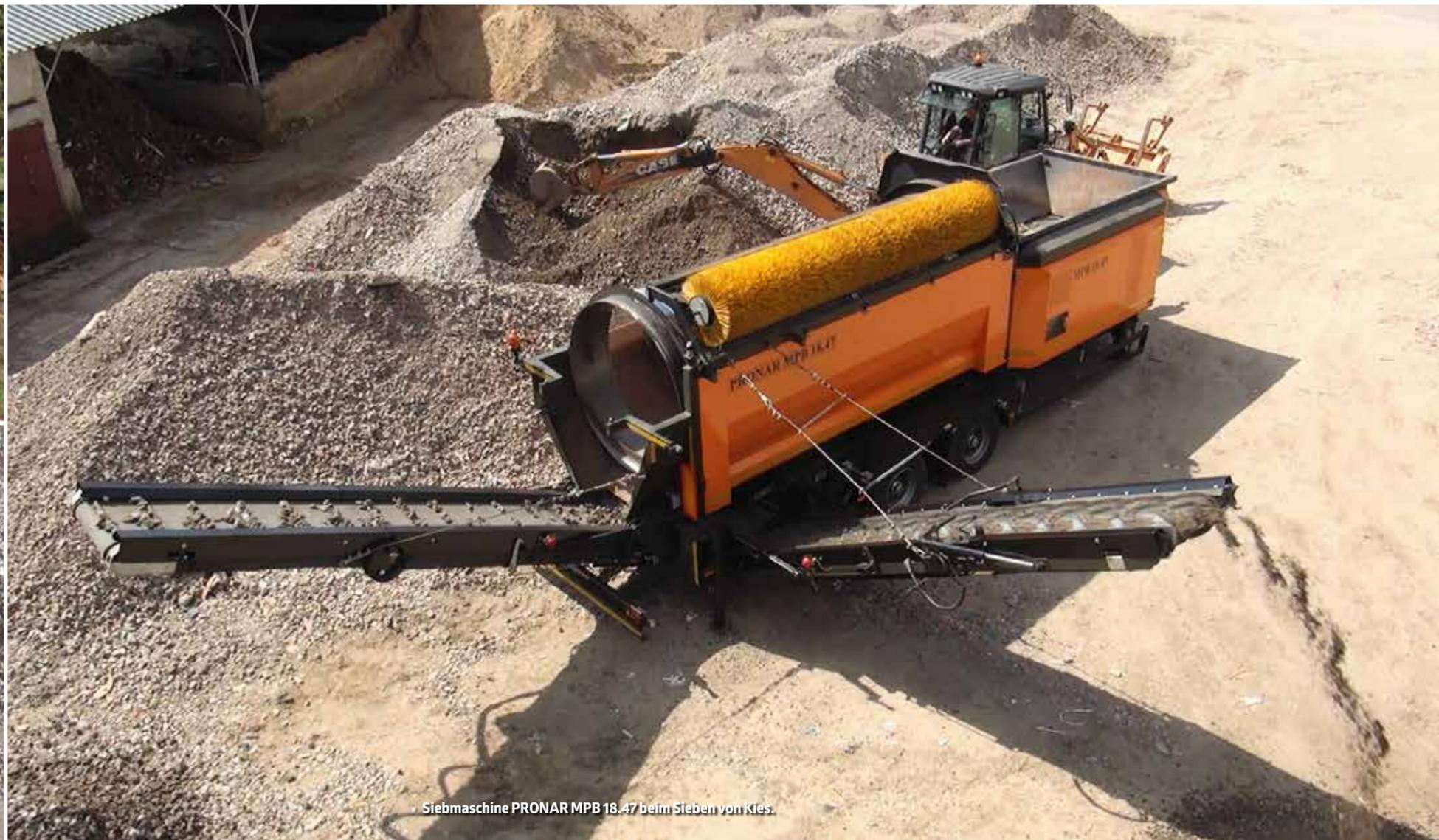
Siebmaschine PRONAR MPB 18.47 beim Sieben von Kies.
