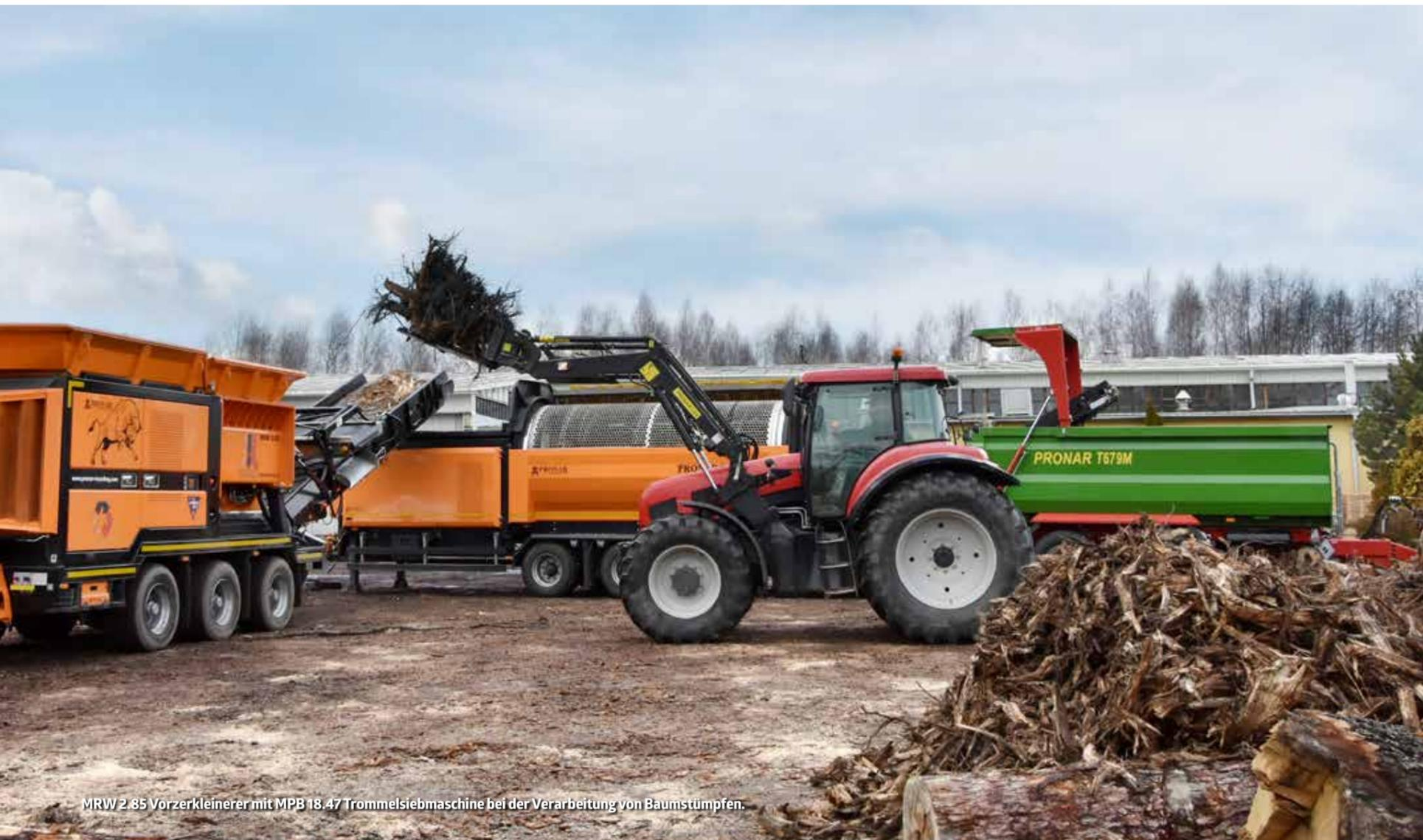
MRW 2.85 Vorzerkleinerer mit MPB 18.47 Trommelsiebmaschine bei der Verarbeitung von Baumstümpfen.
