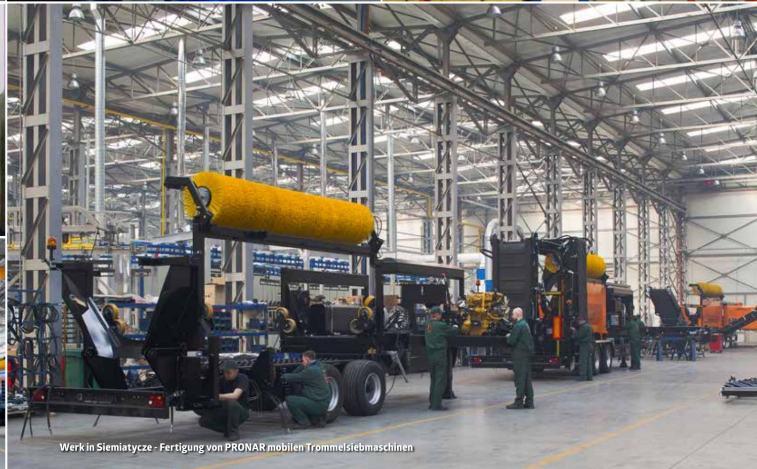
Werk in Siemiatycze - Fertigung von PRONAR mobilen Trommelsiebmaschinen
