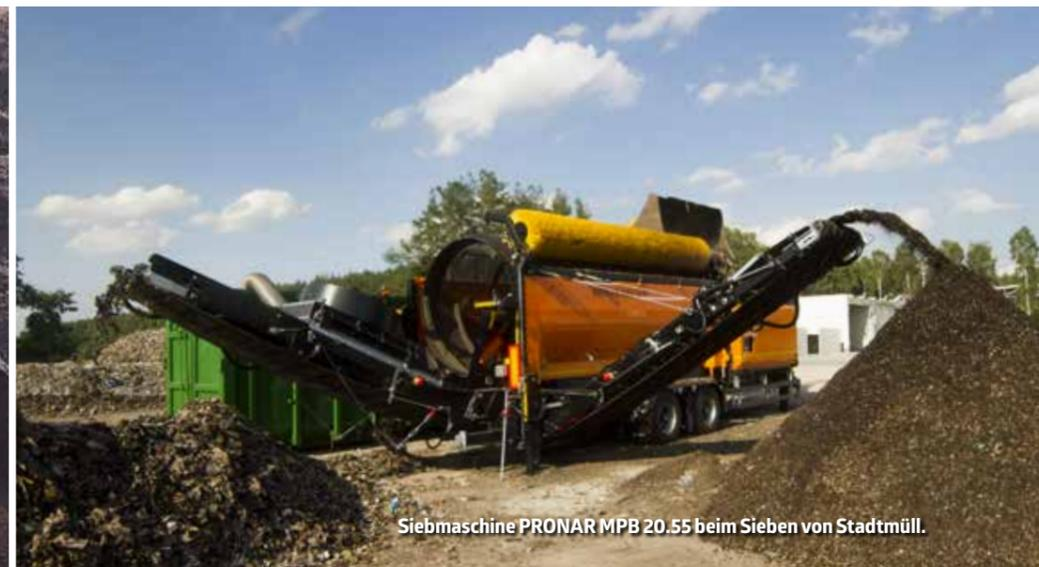
Siebmaschine PRONAR MPB 20.55 beim Sieben von Stadtmüll.
