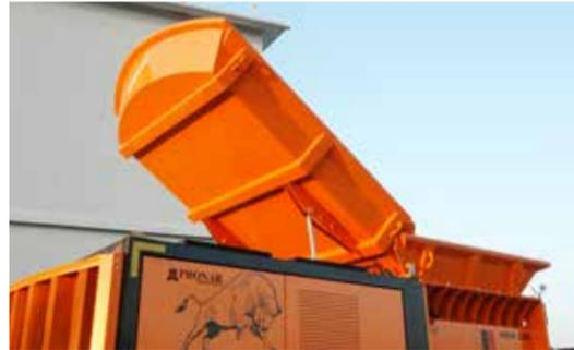
Dank einer Fernbedienung kann über eine hydraulisch angehobene Schütte Material zugeführt werden und die Arbeit des Anwenders erleichtert werden.
