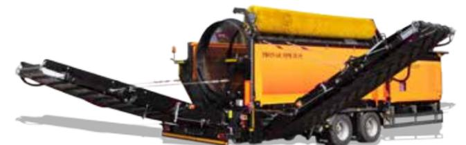
Mobile Trommelsiebmaschine MPB 20.55
