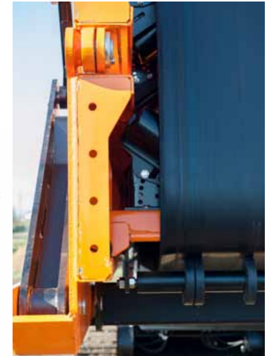
Neigung kann hydraulisch stufenlos verstellt werden
