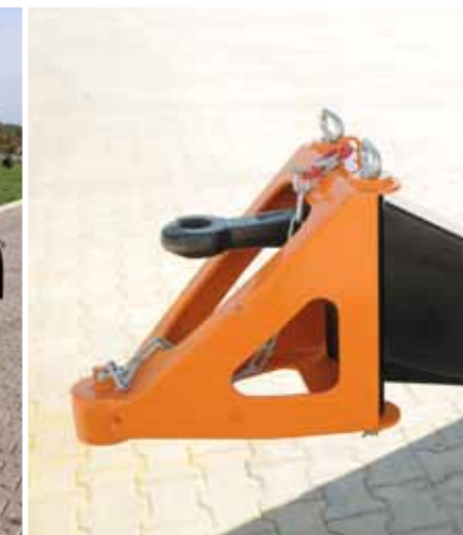
Das Kugelgelenk erlaubt die Umsetzung der Siebmaschine mit Baufahrzeugen.
