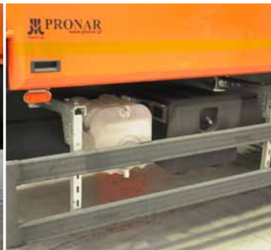
Behälter für Wasser und Flüssigseife als optionale Ausstattung der Maschine.
