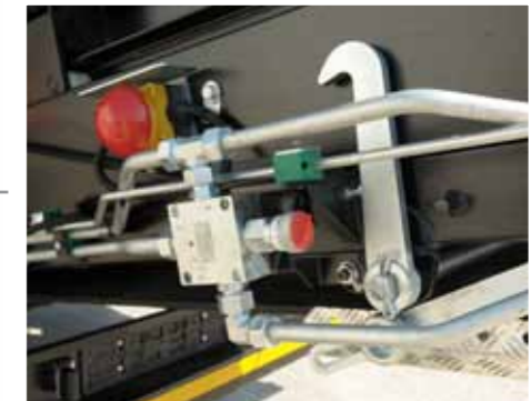
Mit der Regulierung der Förderbandgeschwindigkeit ist die Anpassung der Geschwindigkeit je nach gesiebttem Material möglich, so dass die Leistung der mobilen Trommelsiebmaschine optimal genutzt werden kann. Somit kann auch mehr Material jeder Fraktion aufgeschüttet werden, ohne dass die Maschine verlagert werden muss
