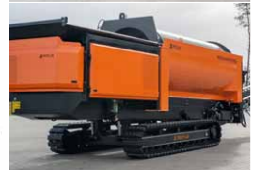
Maschinenrahmen mit hydraulischer Nivellierung in Längsrichtung und einfacher Transportmöglichkeit in unebenen Gelände durch Höhenausgleich
