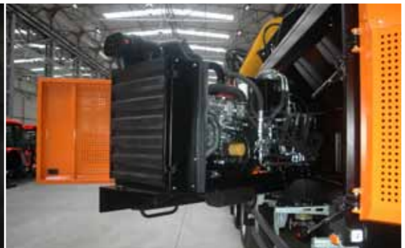
Der Motor und die Hydraulik befinden sich an einem Drehrahmen, was den einfachen Zugang bei Wartungsarbeiten gewährleistet
