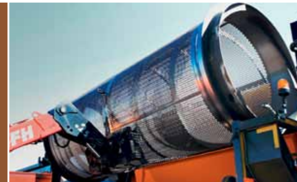
Schneller und einfacher Austausch der Siebtrommel
