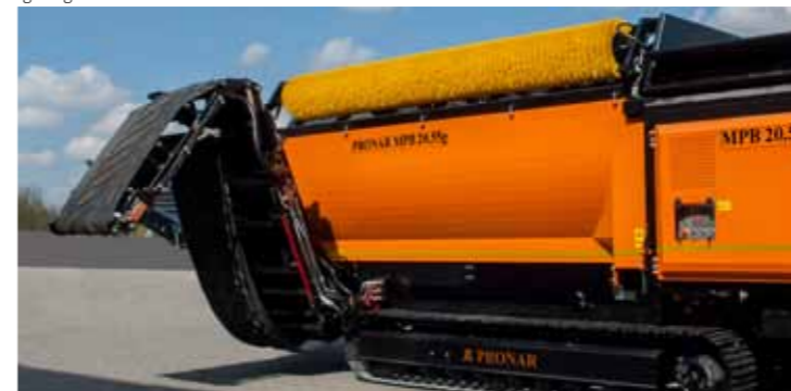
Die Förderbänder ziehen sich an die Außenseite der Maschine zurück - dies berücksichtigt geringere Höhe
