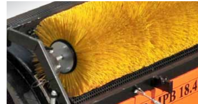
Reinigungsbürste, die hydraulisch gehoben und gesenkt wird
