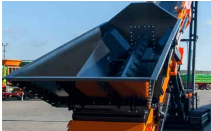
Verschleißplatten im Übergabebereich
