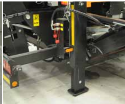
Die hydraulischen Stützfüße verbessern den Arbeitskomfort des Maschinenführers und sorgen für bessere Stabilität der Maschine im Betrieb
