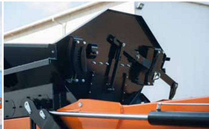
Hydraulisch klappbar Aufgabebetrücker
