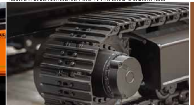
Raupenantrieb zum Bewegen der Maschine ohne zusätzliches Zugfahrzeug
