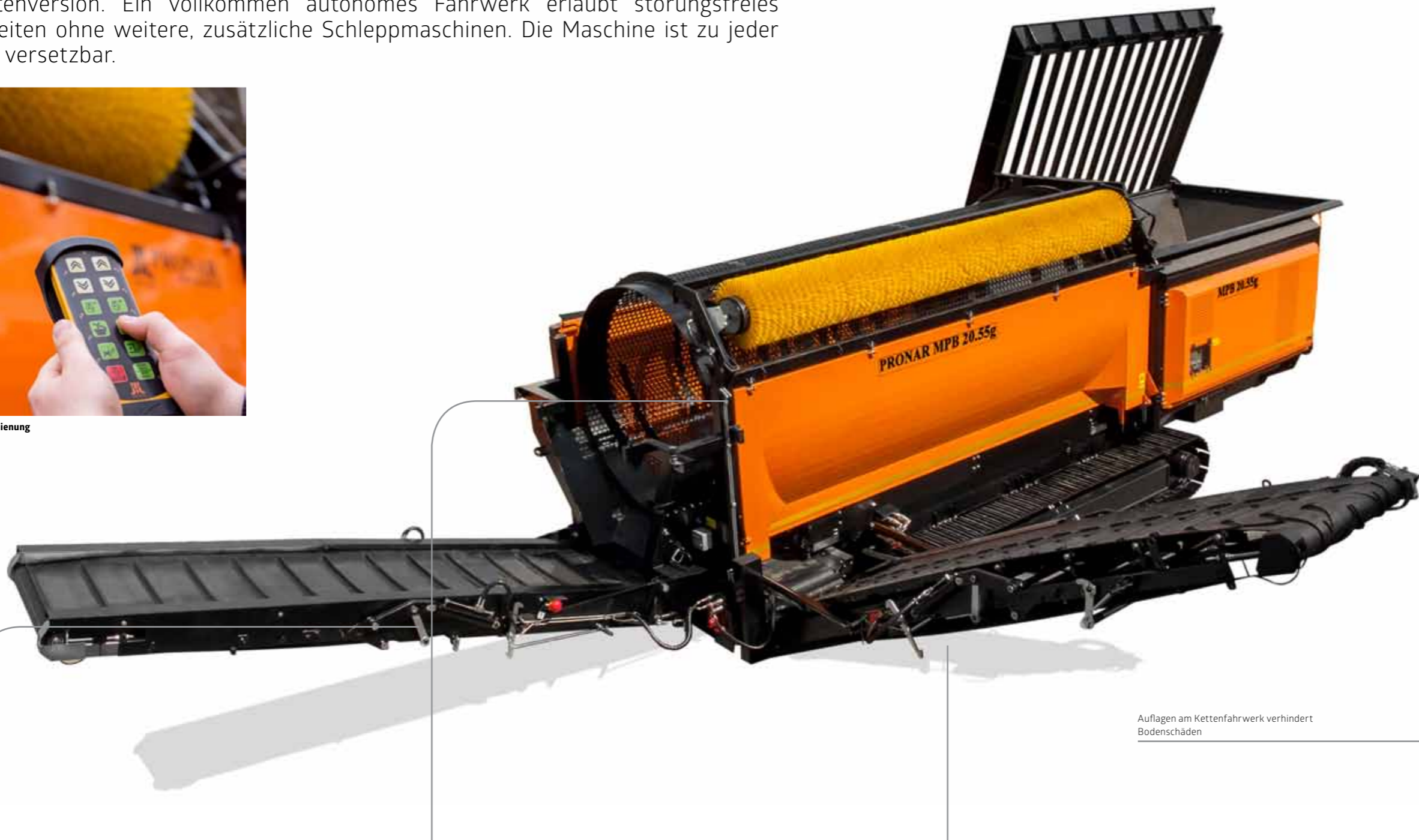
Die Förderbänder ziehen sich an die Außenseite der Maschine zurück - dies berücksichtigt geringere Höhe
