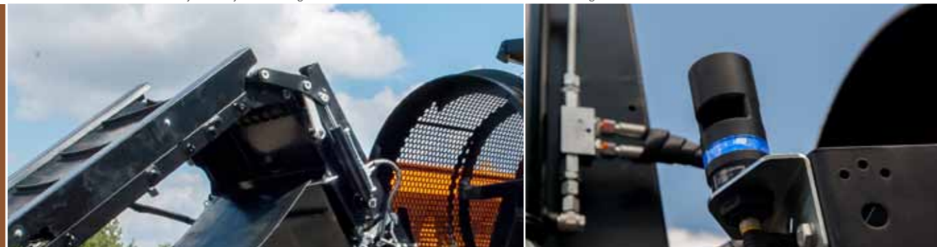
Heckförderband wird durch zwei Hydraulikzylinder bewegt
