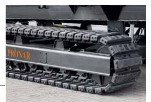
Maschinenrahmen mit hydraulischer Nivellierung in Längsrichtung und einfacher Transportmöglichkeit in unebenen Gelände durch Höhenausgleich
