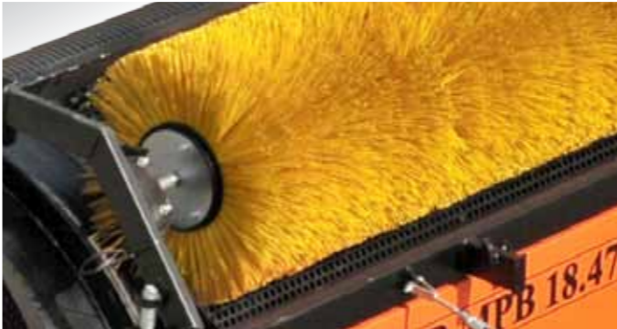
Щетка для очистки барабана опускается и поднимается с помощью гидравлики.
