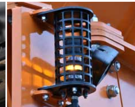
Проблесковый маячок для сигнализации режима работы.
