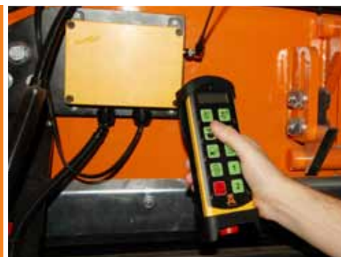
Пульт дистанционного управления позволяет оператору регулировать рабочие параметры машины, не выходя из кабины погрузчика.
