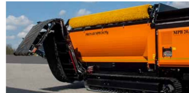
Конвейеры складываются снаружи, позволяя на более низкую высоту.
