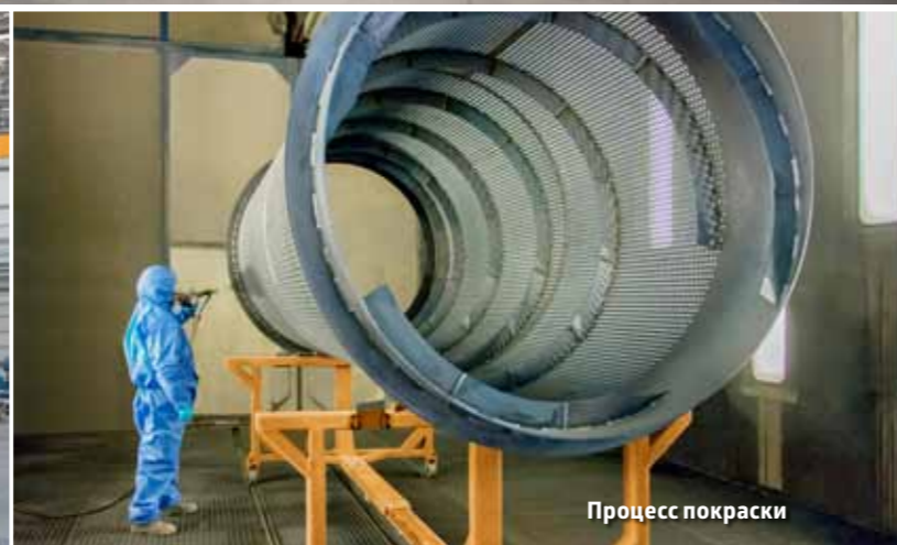
Завод в Семятичах - установка Мобильных Барабанных Просеивателей и Мобильных Низкоскоростных Измельчителей Pronar
