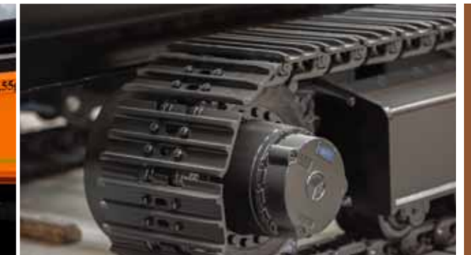
Привод позволяет перемещать машину без дополнительных тягачей.
