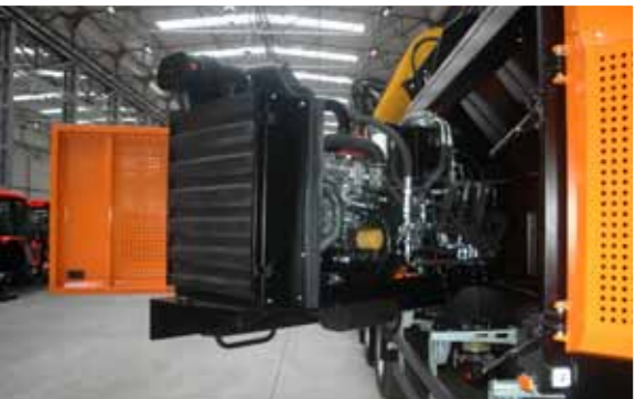
Двигатель и гидравлическая система размещаются на поворотной раме, что обеспечивает удобный доступ при проведении сервисных работ
