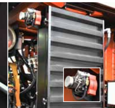
Система Cleanfix автоматически очищает радиатор двигателя и радиатор гидравлического масла.
