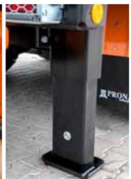
Гидравлические задние опорные ноги улучшают устойчивость машины во время работы.
