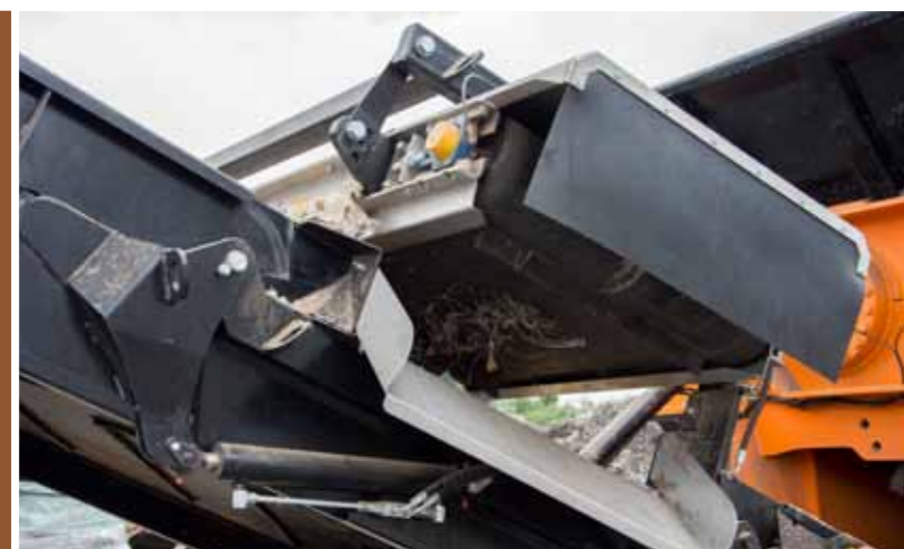
Гидравлически регулируемый магнитный сепаратор для отделения ферромагнетиков.
