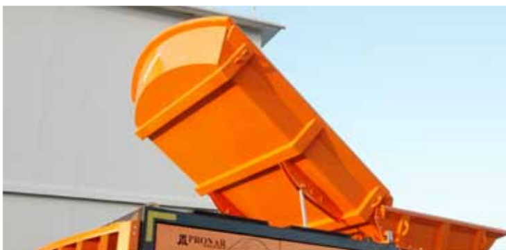
Гидравлически поднимаемый скат облегчает введение негабаритных материалов в рабочую камеру.
