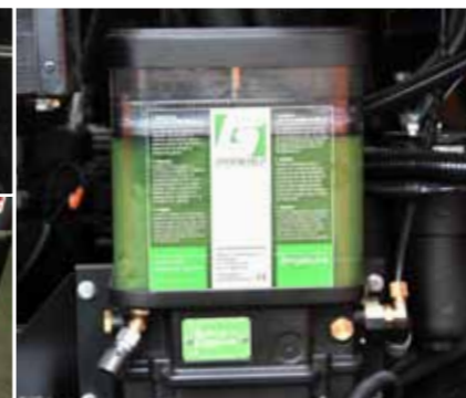
Центральная система смазки обеспечивает хорошее состояние наиболее важных элементов машины. Имеется в двух размерах.
