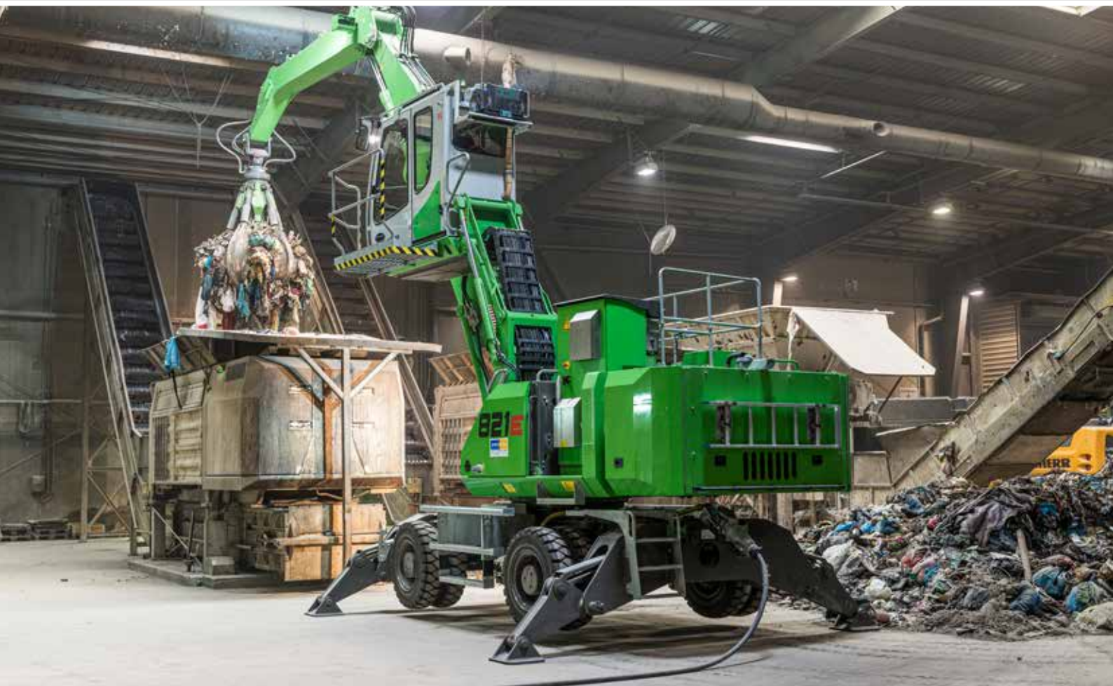
821 Mobil Elektro mit Powerpack als Gegengewicht für flexibles Verfahren und Stromzufuhr über Schleppkabel; Deutschland 821 Mobil electro - with Powerpack as counterweight for flexible movement and trailing cable power supply; Germany
