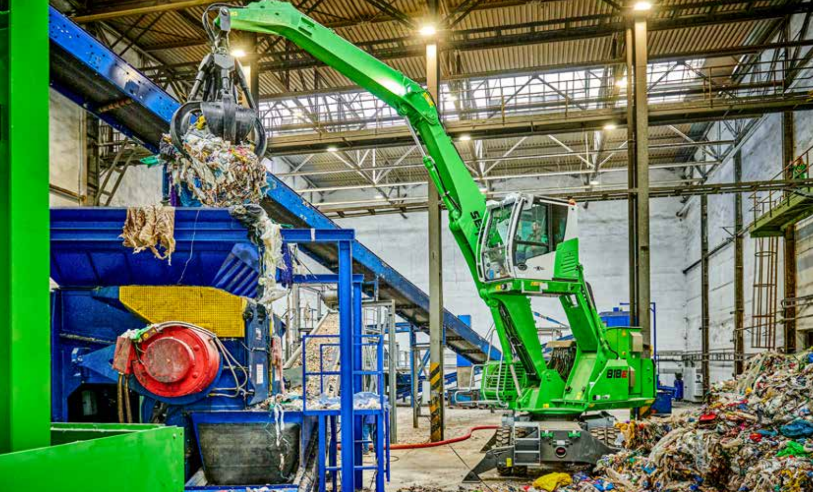
818 Mobil Elektro mit Schleppkabel; Tschechien 818 Mobile electric solution with trailing cable; Czech Republic
