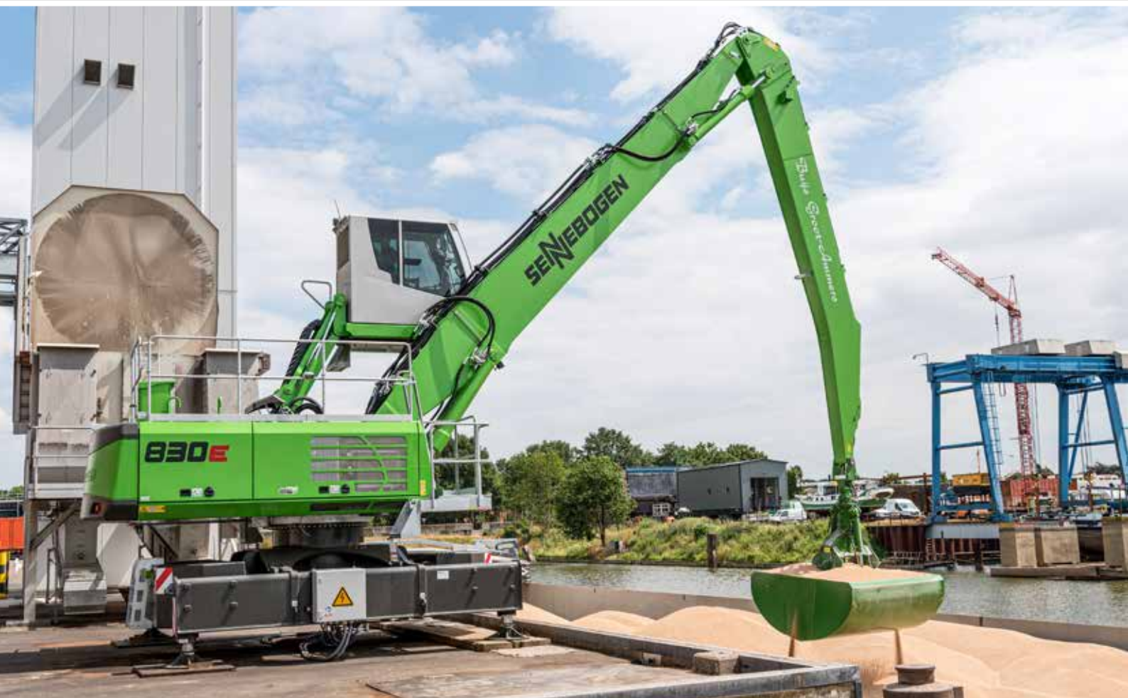
830 Elektro mit stationärem 4-Punkt-Untergestell; Niederlande 830 stationary electric solution with 4-point pedestal; Netherlands
