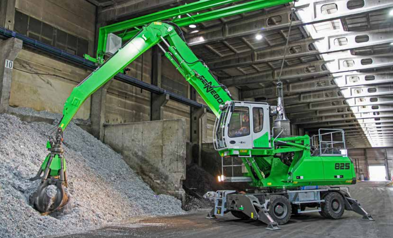
825 Mobil Elektro mit Deckenstromzuführung über mitfahrenden Brückenkran; Deutschland 825 Mobile with ceiling power supply via overhead bridge crane; Germany
