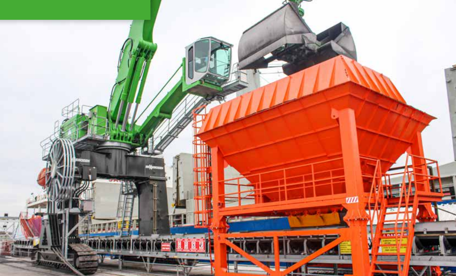
875 Raupenportal Elektro – mit spiraligwickelnder Motorleitungstrommel; Türkei 875 electric crawler gantry - with spirally winding motorized cable reel; Turkey
