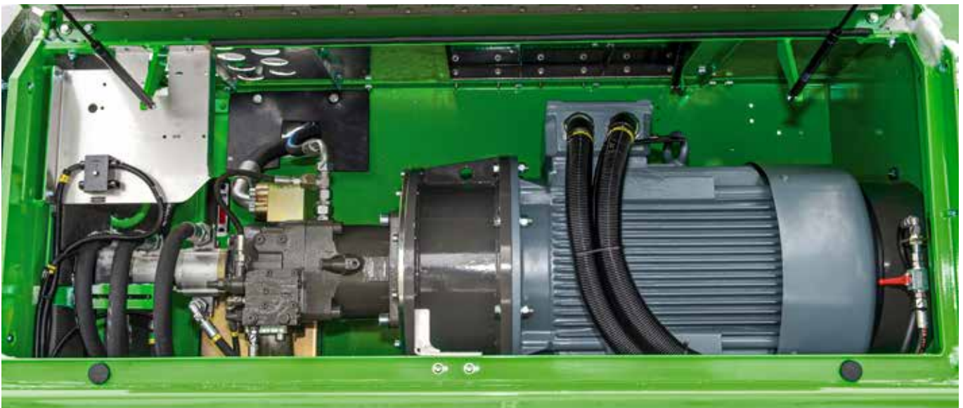
Zukunftsorientierte elektrohydraulische Antriebe: Sparsam, umweltfreundlich, langlebig Future-oriented electro-hydraulic drives: Economical, environmentally-friendly, long-living
