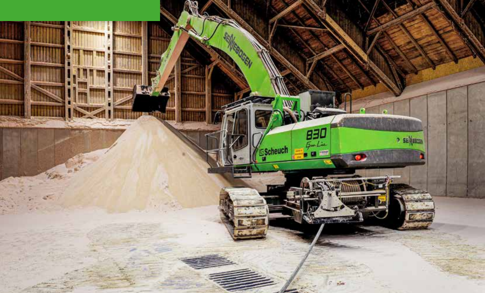
830 Raupe Elektro mit breit wickelnder, zylindrischer Motorleitungstrummel mit Spulvorrichtung; Deutschland 830 Crawler electro with cylindrically winding motor cable reel with spooling device; Germany
