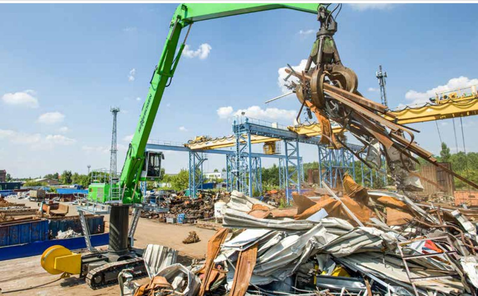
835 Raupe Elektro mit zylindrischer Motorleitungstrommel; Deutschland 835 Crawler electro with cylindrically winding motor cable reel; Germany
