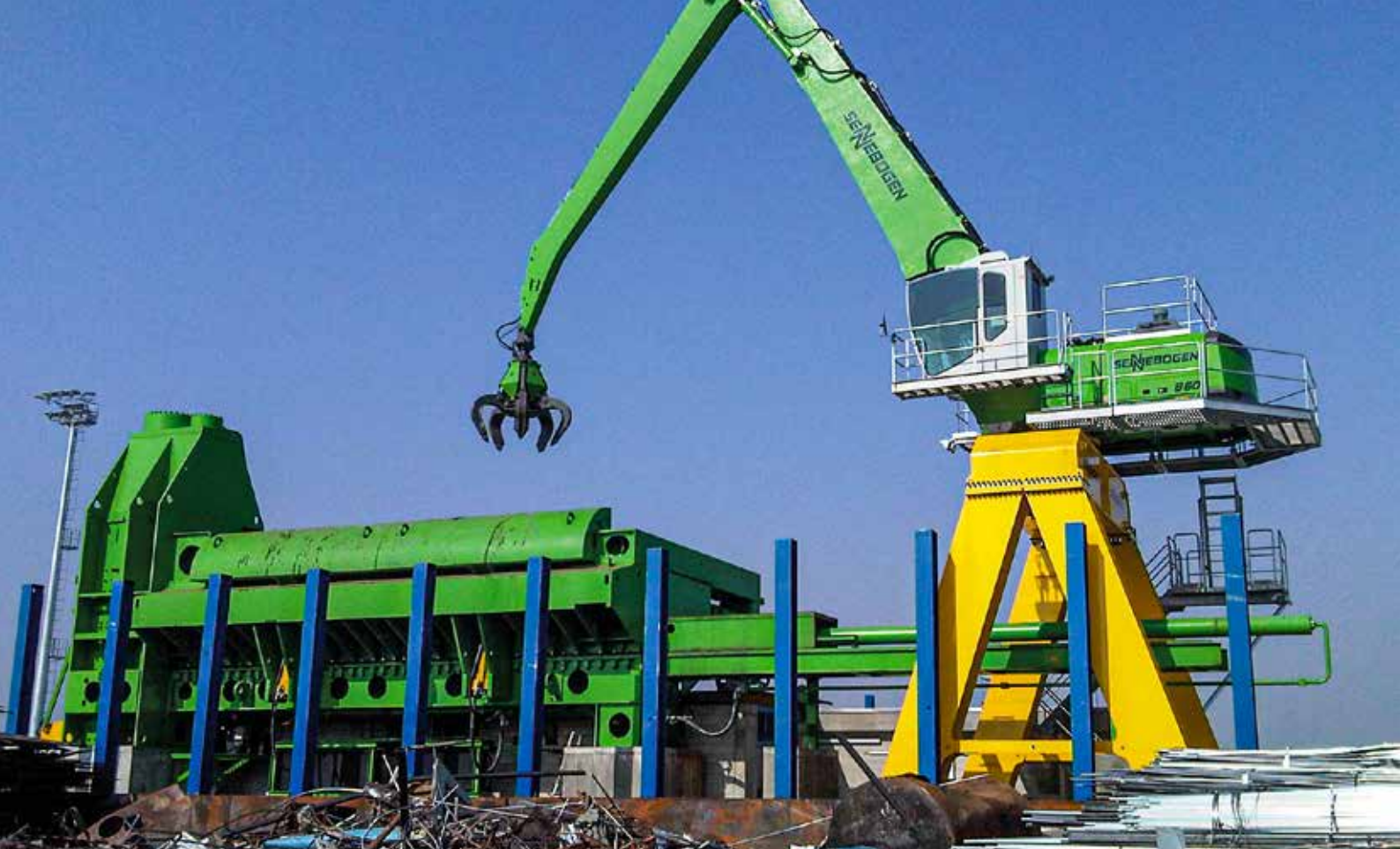
860 stationäres Portal Elektro, Scherenbeschickung; Italien 860 stationary gantry electro, shear feeding; Italy
