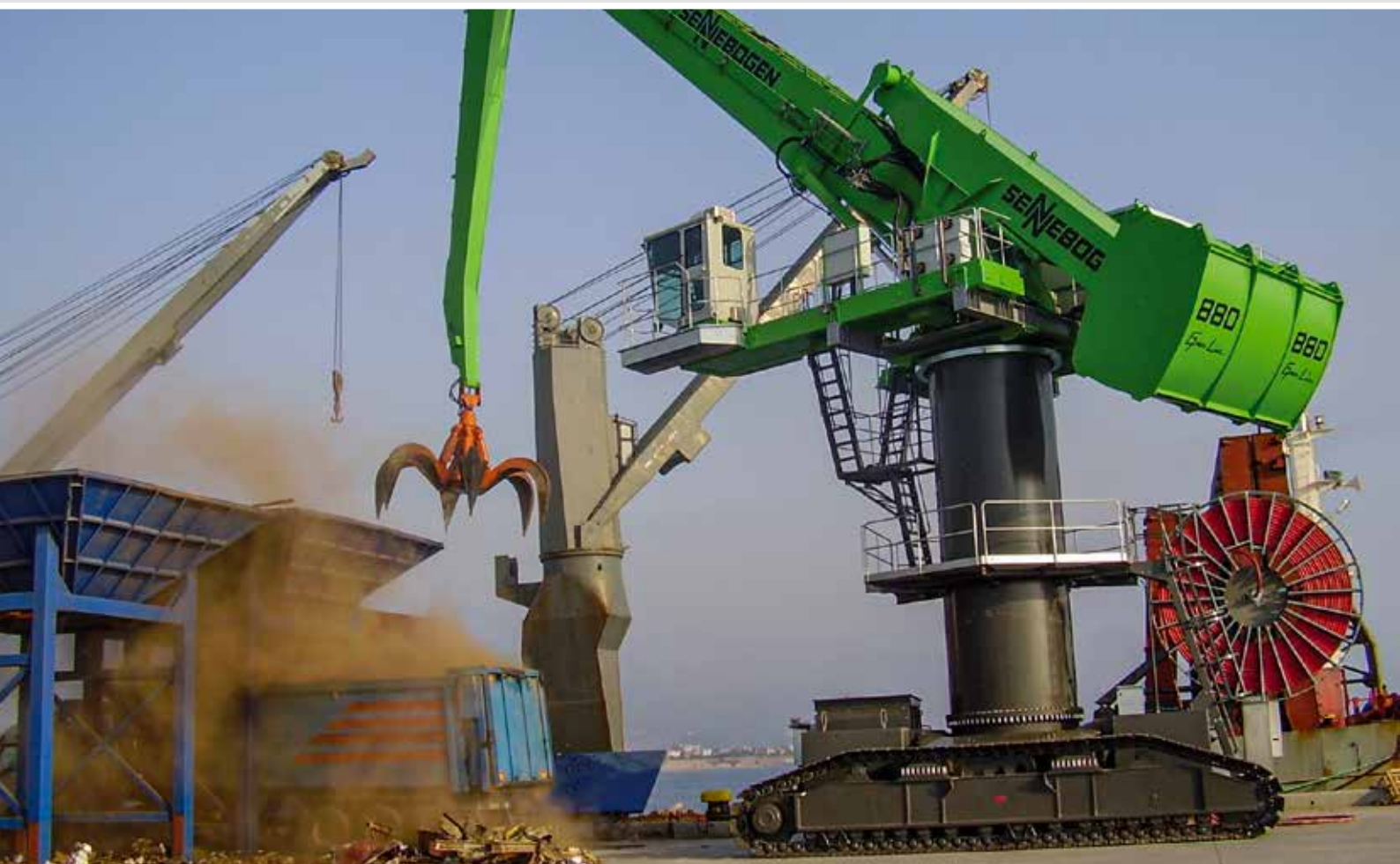
880 EQ Raupe Elektro mit Pylon und spiralig wickelnder Motorleitungstrommel; Türkei 880 EQ crawler electro with pylon and monospiral motor cable reel; Turkey
