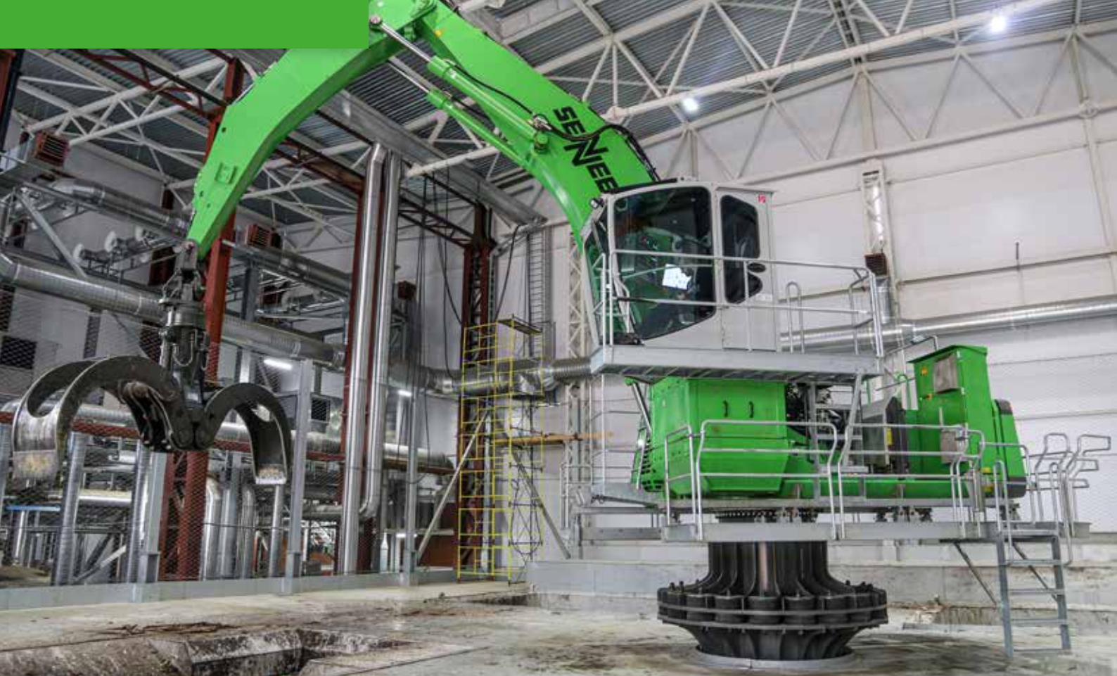
835 Stationär Elektro mit Elastiklager in einer Halle; Russland 835 stationary, indoor electric solution with elastic bearing; Russia
