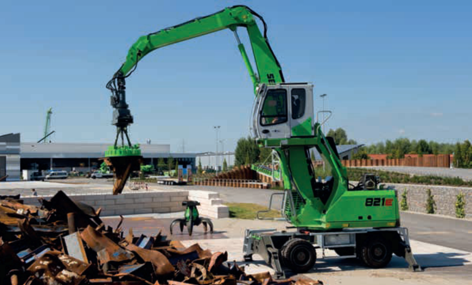
SENNEBOGEN Multitool - vollhydraulisches Wechselsystem für hängende Anbauwerkzeuge (Magnet) SENNEBOGEN Multitool - fully-hydraulic change device for hanging attachments (magnet)
